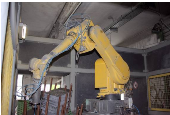
High-Tec über und unter Tage: Hier ein Roboter zum vollautomatischem Zuschneiden in der Dachschieferproduktion und die Abbausäge unter Tage.
