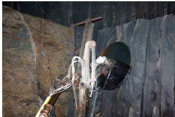
High-Tec über und unter Tage: Hier ein Roboter zum vollautomatischem Zuschneiden in der Dachschieferproduktion und die Abbausäge unter Tage.
