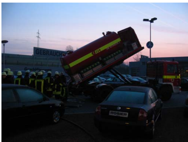
Wechselader mit AB-Schaum der BF Dortmund in Arbeitsstellung.
